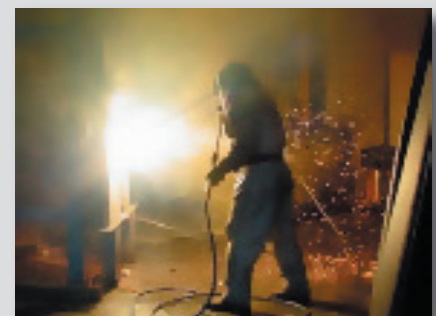
Selbst den aggressivsten elektro-mechanischen und thermischen Angriffswerkzeugen haben die Werteschutzräume standgehalten
