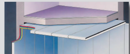
Verstärkung bestehender Massivbau-Tresorräume mit Relastan®-Elementen
