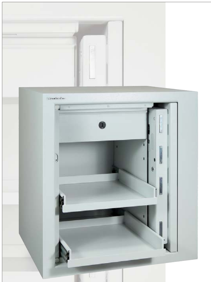
Abb. Einschwenktürtresor CWP0901, Türbandung rechts K-Schloss Secu 2 Schlüssel (125 mm), 1 versperrbare Lade, 2 Auszugstabelle
